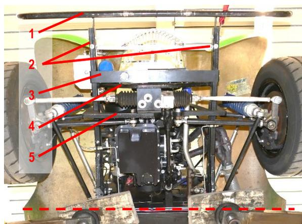
Abb. 21: Frontstruktur mit Motorraumtrennung (rote gestrichelte Linie), Ansicht von unten
