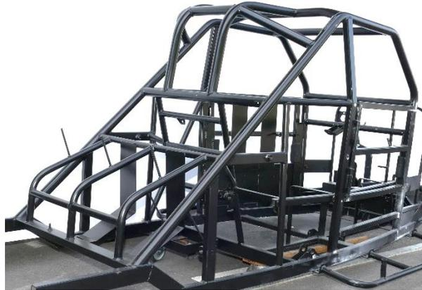
Abb. 1: Sicherheitskäfig, Ansicht von hinten rechts
