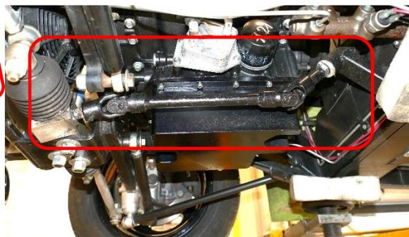
Abb. 16: Lenksäule Motorraum, Ansicht von unten links
