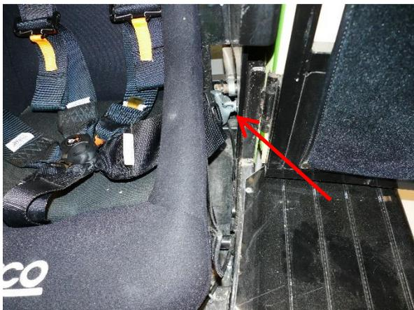
Abb. 10: Unterer linker Gurtverankerungspunkt, Ansicht von vorne
