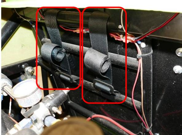
Abb. 8 Obere Gurtverankerungspunkte am Sicherheitskäfig,
