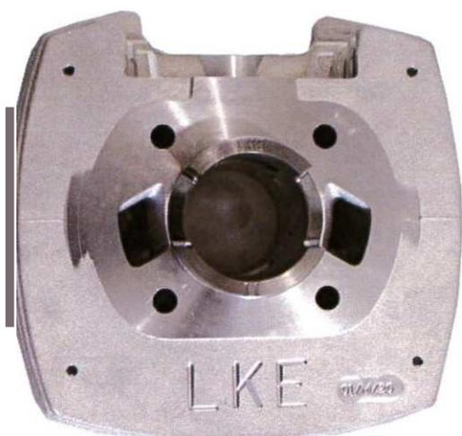
FOTO DELLA CAMERA 01 COMBUSTIONE
