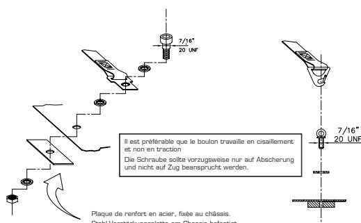
Plaque fixée au châssis et renforcée de l'autre côté par une plaque de renfort.
