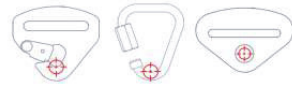
Exemples de points de rotation de l'ancrage de sangle Beispiele von Drehpunkten der Gurtbefestigung
